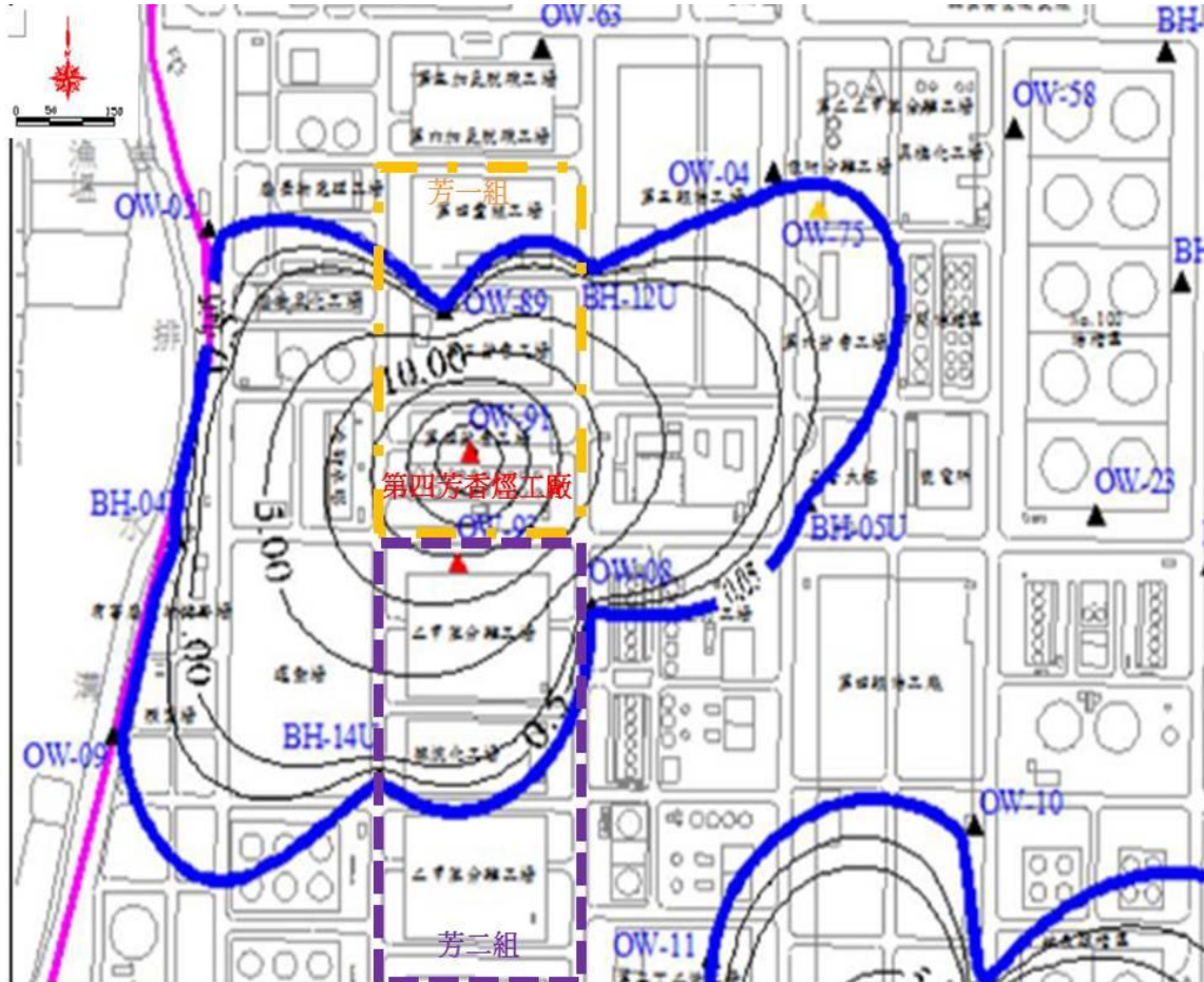
圖 4-5 試驗場址所處場區地下水苯污染濃度分布範圍推估示意圖
