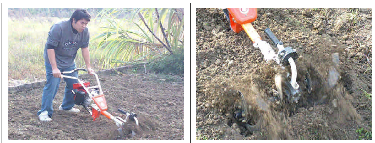
小鐵牛進行土壤破碎、翻拌
