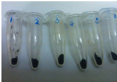
圖20 已完成表面改質之氧化鐵奈米顆粒
