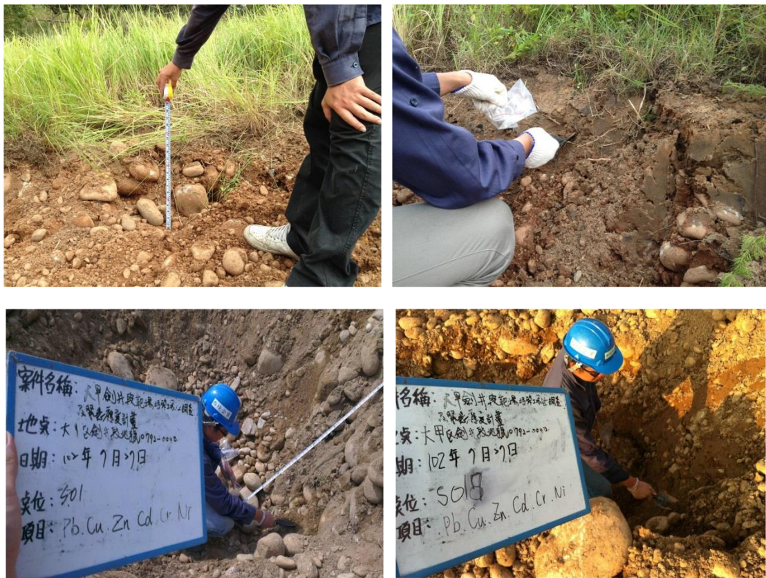
圖 3.4 土壤污染場址的現勘及採樣(a)現勘並且量測，(b)人工採樣，(c)採樣並且作紀錄及(d)多區域採樣
