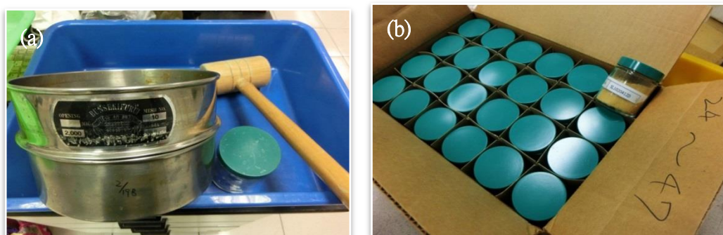
圖 3.7 過篩土樣之(a)10 號篩及(b)過篩後樣品裝罐
