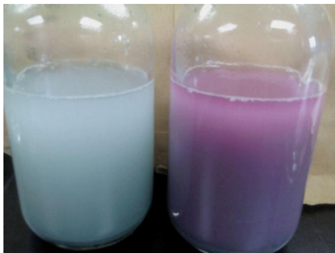
圖 53. Cu/Al 與 B_{12} -Cu/Al 批次反應比較圖 (改變合成方法)
