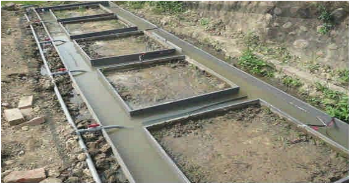
圖 1.11 電動力整治鉛污染農地現場系統圖
