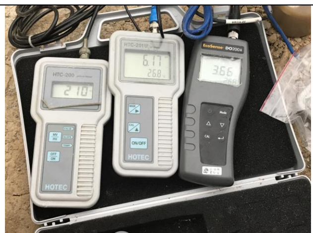
現場導電度、pH、溶氧監測(2018.06.06)
