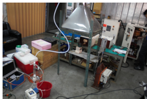
圖 9 玻璃化實驗採集空氣污染物裝置圖
