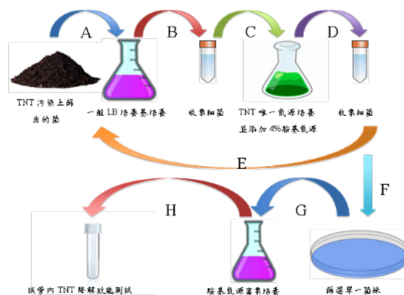
圖 1 篩選易被胺基氮源生物刺激並能高效分解 TNT 之菌株。
