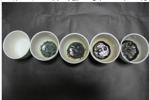
圖 6 在高溫 1100°C 下底泥玻璃化之成品
