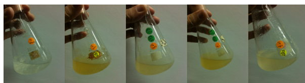
圖 2 篩選易被胺基氮源生物刺激並能高效分解 TNT 之菌株。(左起依序為 Blank、T1、T2、N1、N2)
