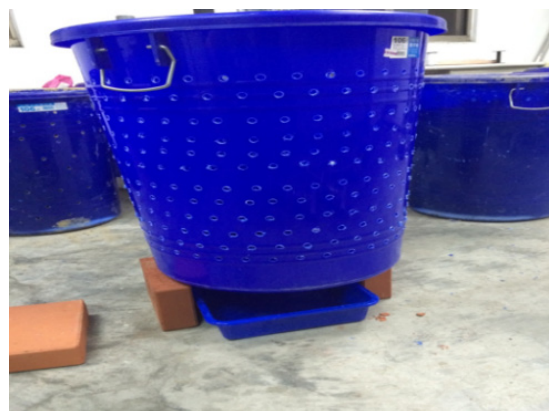
圖1 土壤生物通氣模場通氣孔洞
