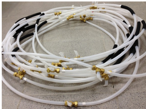
圖 4 30 米長串聯式多孔隙管
