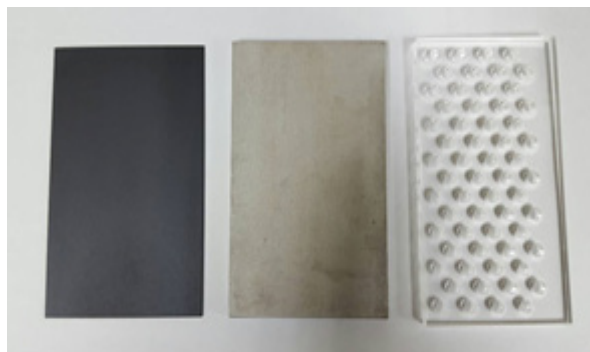
圖 2. 電動力系統之電極與多孔夾層 (陽極、陰極與 PVC 夾層)
