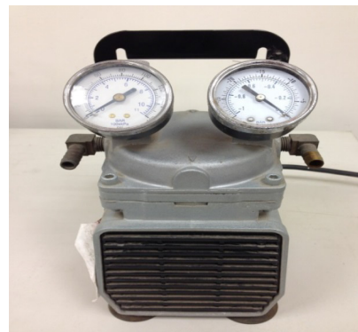
圖 1 44.5 L/min 流量之小型抽氣機
