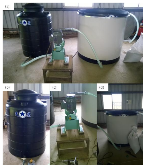
圖 4 實驗室廠型模組(a)模組(b) 原液槽(c) 進樣定量馬達(d)反應槽
