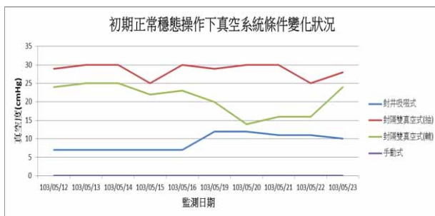
圖 6 各浮油回收系統操作時管道所形成之真空條件
