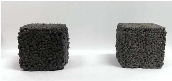
圖 5 透水性混凝土反應材 (a) 4-8 mesh A 型複合材； (b) 25% 4-8 mesh、40% 8-16 mesh、35% 小於 16 mesh A 型複合材
