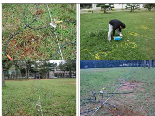
圖 4 現場試驗各種電極排列施測照片
